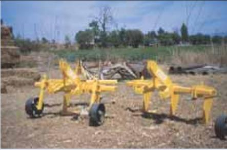
■ Implementos para labranza de conservación, útil para descompactar potreros sin generar erosión eólica.
